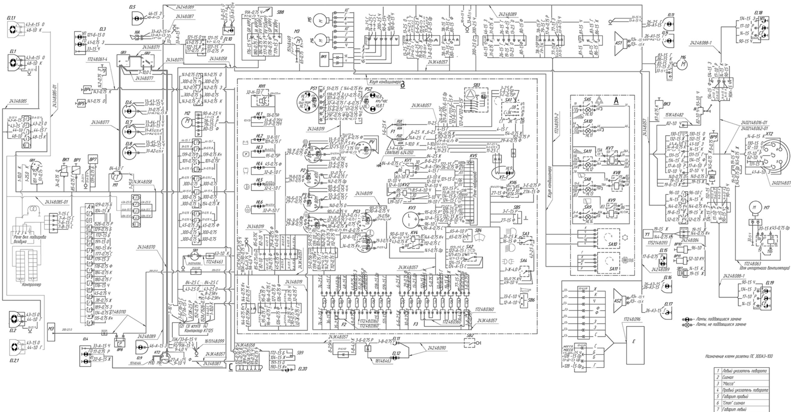
Рисунок 13 – Схема электрическая соединений электрооборудования трактора ХТЗ – 243К.20
